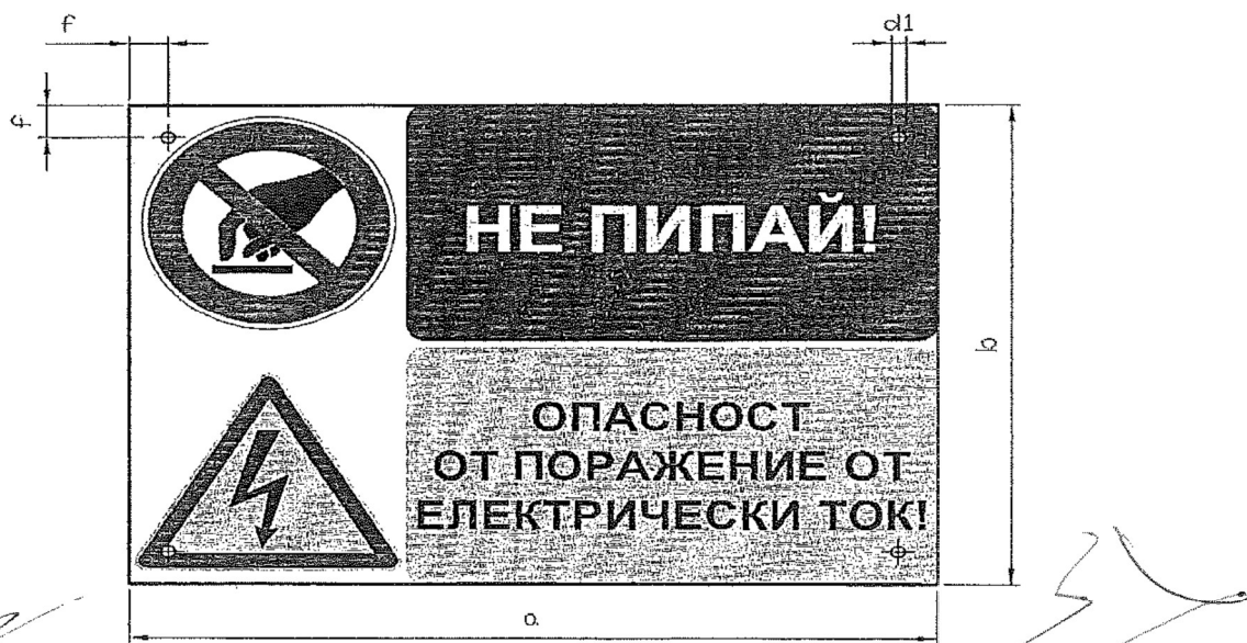
Фиг. 2 Табела „Не пипай! Опасност от поражение от електрически ток!“
